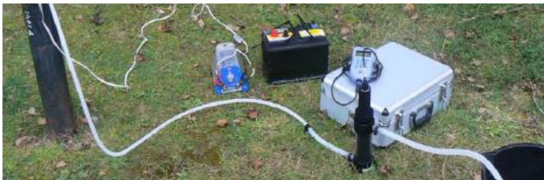
使用流通池装置测量地下水
